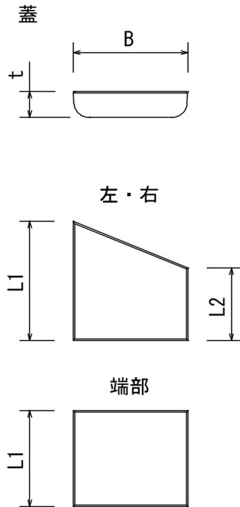
4本・5本使い共に 本体の断面寸法(a~t)は、リボーン側溝と同じ寸法になります。
