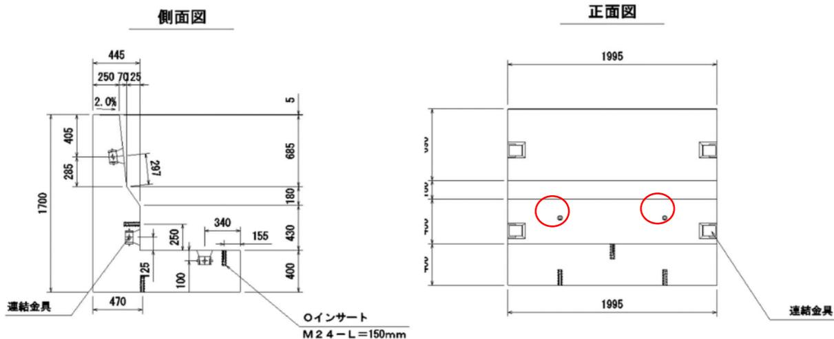
赤印の2カ所で吊り上げます。M24 のフレノリンクボルトを使用します。製品重量 W-5067kg/本
