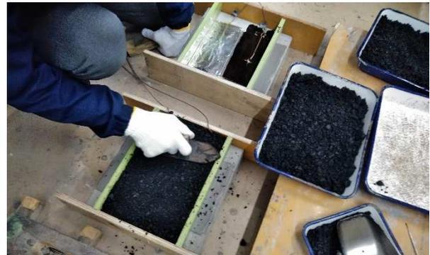
図-2：加熱アスファルト敷設状況
