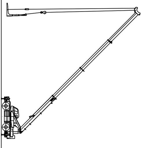
①親フックは縦壁 子フックは底版にセットし吊り上げる
